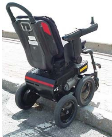
図2 4輪機能による段差越え
